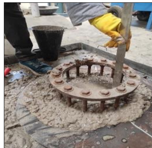
Figure 3(d) J ring Test
