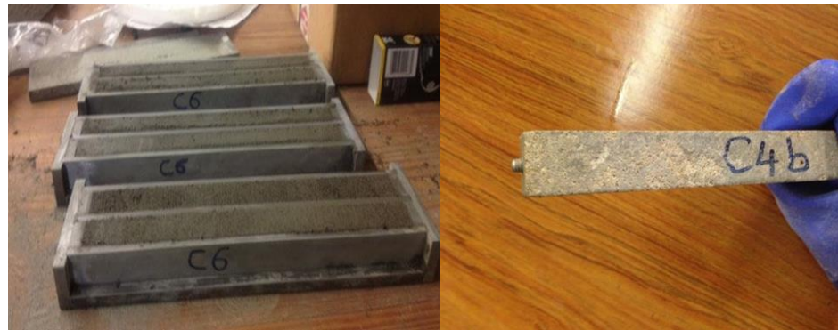
Figure 6. AMBT molds and mortar bars pour for AMBT test
