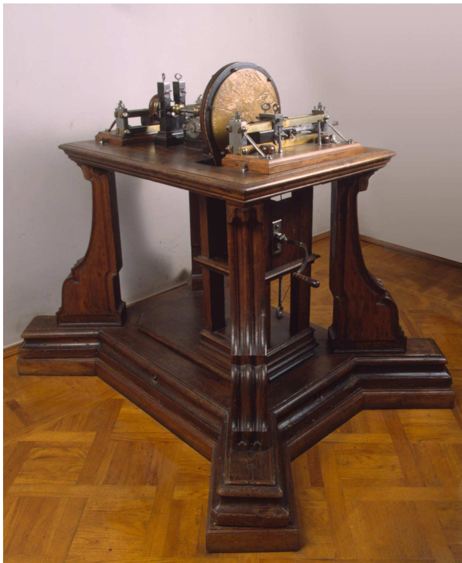
Фото. 18. Токарно-копировальный медальерный станок Ф. Зингера, А. Нартова, 1710 г. Станок предназначался для изготовления медалей по образцу большого размера в автоматическом режиме. (Государственный Эрмитаж, Санкт-Петербург, www.hermitagemuseum.org ).
