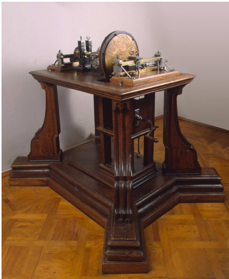
Фото. 18. Токарно-копировальный медальерный станок Ф. Зингера, А. Нартова, 1710 г. Станок предназначался для изготовления медалей по образцу в автоматическом режиме. (Государственный Эрмитаж, Санкт-Петербург, www.hermitagemuseum.org ).
