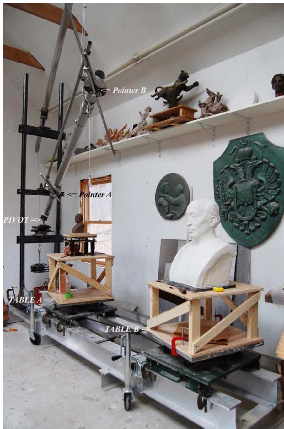
Рис. 2. Современный 3D-пантограф, используемый скульпторами (M. Keropian, www.keropiansculpture.com ). 3D-пантограф позволяет пропорционально увеличивать или уменьшать объёмную фигуру. Пантограф имеет раму, на которой расположены две поворотные платформы. На одну платформу (Table A) устанавливают модель, на другой платформе (Table B) располагается увеличенная копия модели. К раме с помощью шаровой опоры (Pivot) крепится стрела. Стрела снабжена противовесом. На стреле имеются цилиндрические шарниры, к которым прикреплён параллелограммный механизм. На одном плече параллелограммного механизма закреплён острый щуп (Pointer A), на другом – острый указатель (Pointer B). Платформы, благодаря цепной передаче, можно синхронно поворачивать вокруг своих вертикальных осей, подставляя под щуп/указатель разные стороны модели/копии. Если коснуться щупом модели, то указатель покажет, где в пространстве находится соответствующая точка увеличенной копии.
