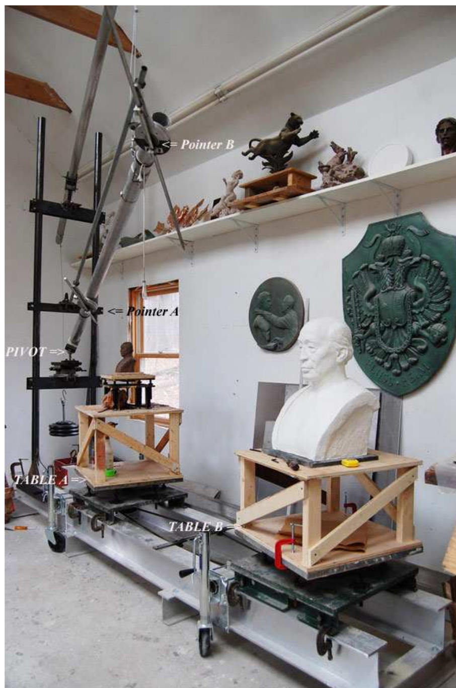
Рис. 2. Современный 3D-пантограф, используемый скульпторами (М. Keropian, www.keropiansculpture.com ). 3D-пантограф позволяет пропорционально увеличивать или уменьшать объёмную фигуру. Пантограф имеет раму, на которой расположены две поворотные платформы. На одну платформу (Table A) устанавливают модель, на другой платформе (Table B) располагается увеличенная копия модели. К раме с помощью шаровой опоры (Pivot) крепится стрела. Стрела снабжена противовесом. На стреле имеются цилиндрические шарниры, к которым прикреплён параллелограммный механизм. На одном плече параллелограммного механизма закреплён острый щуп (Pointer A), на другом – острый указатель (Pointer B). Платформы, благодаря цепной передаче, можно синхронно поворачивать вокруг своих вертикальных осей, подставляя под щуп/указатель разные стороны модели/копии. Если коснуться щупом модели, то указатель покажет, где в пространстве находится соответствующая точка увеличенной копии.
