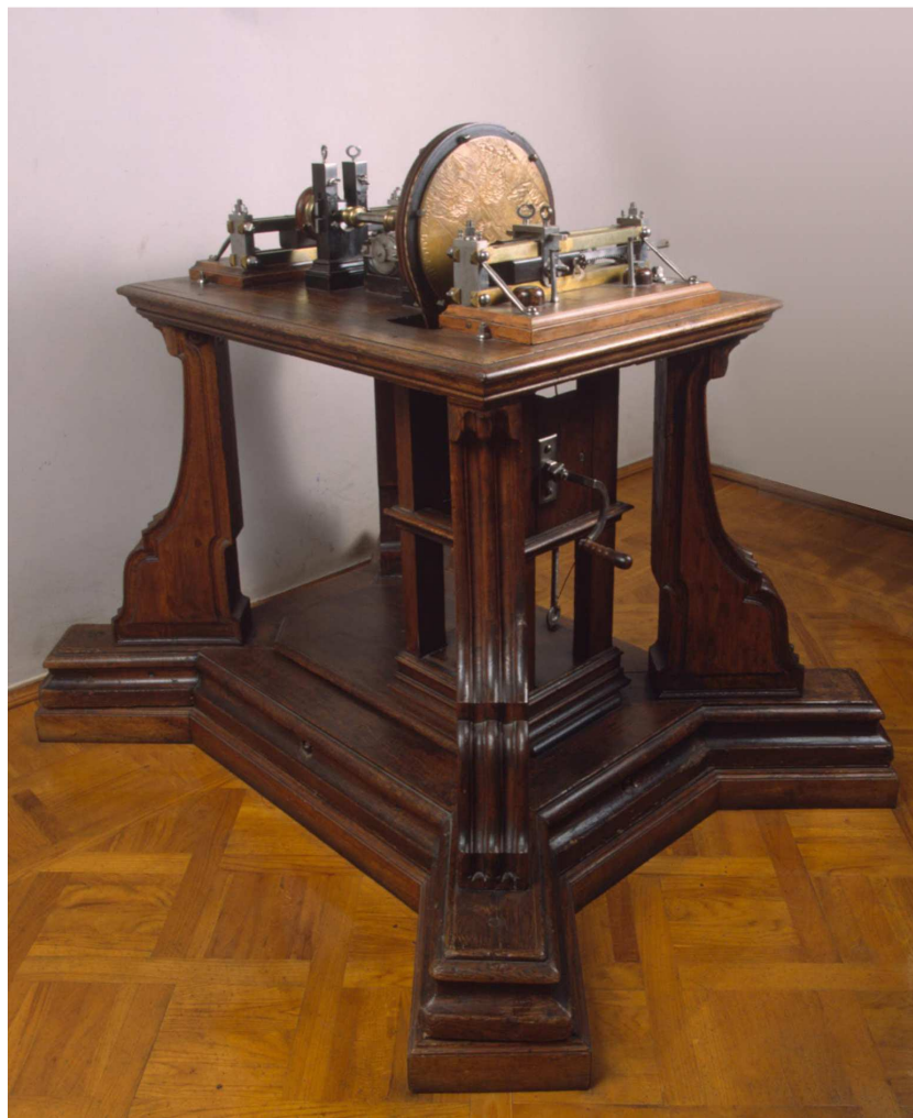
Фото. 20. Токарно-копировальный медальерный станок Ф. Зингера, А. Нартова, 1710 г. Станок предназначался для изготовления медалей по образцу большого размера в автоматическом режиме. (Государственный Эрмитаж, Санкт-Петербург, www.hermitage-museum.org ).
