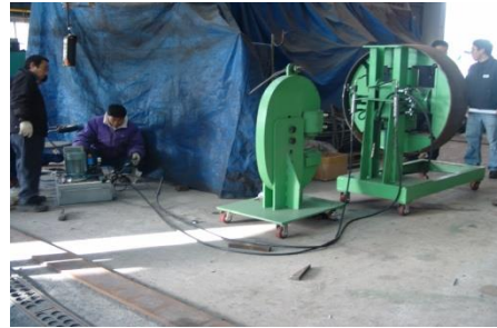
(d) Operation of C-type Jig
