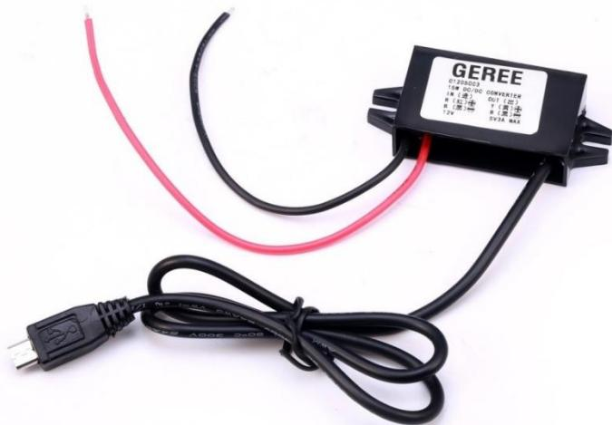
5. Prepare el siguiente cableado para alimentar la Raspberry Pi y el sensor ultrasónico con 5V en lugar de 12V.
