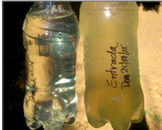
Figure N°4. Effluent and affluent sample
