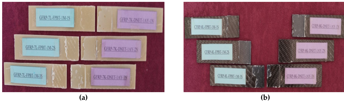
Figure 23. GFRP-7L-FPBT-1M numunesi (a) ve CFRP-8L-FPBT-1M numunesinin (b) dört nokta eğme test sonrası görünümleri.
