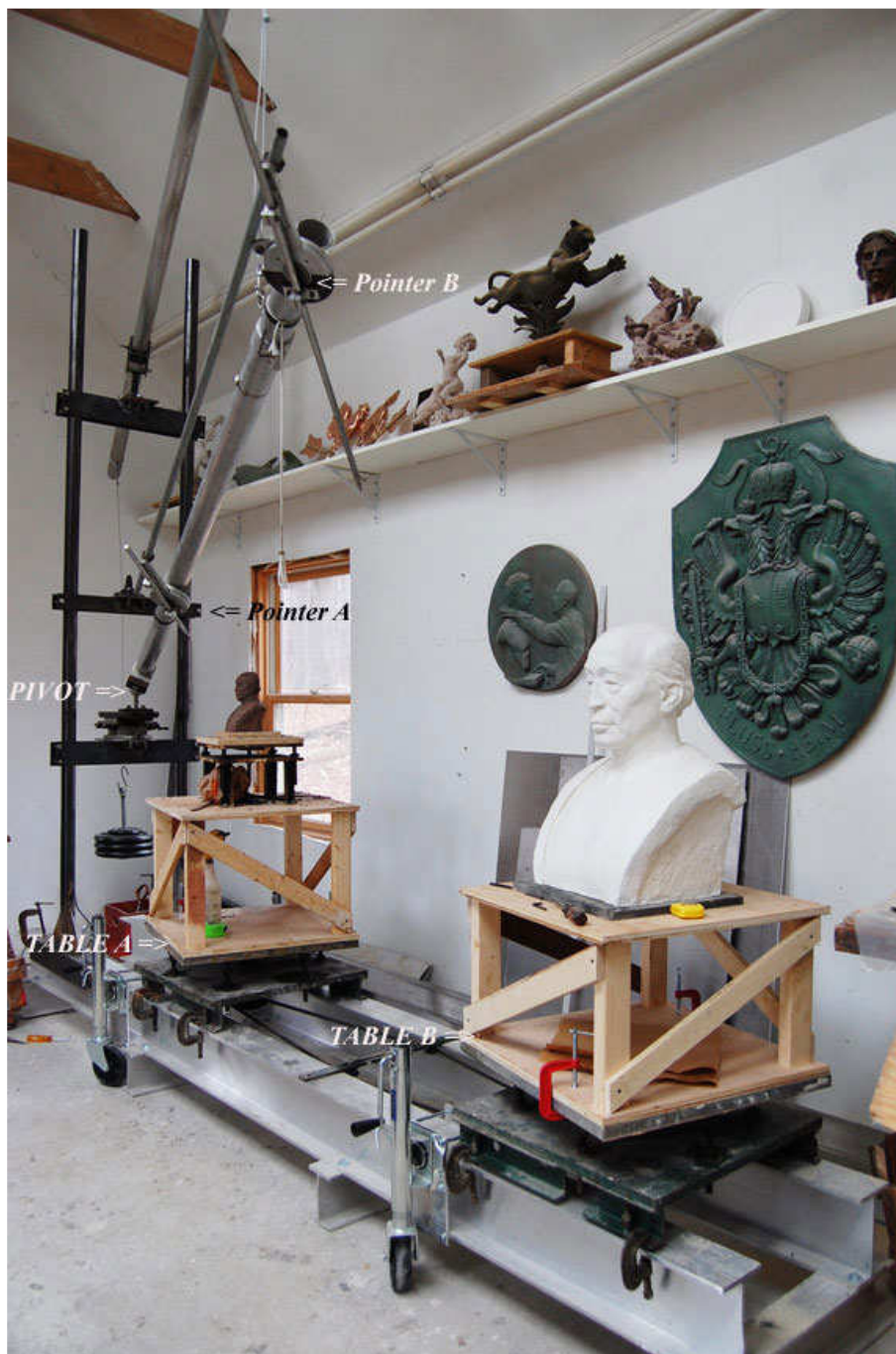
Рис. 2. Современный 3D-пантограф (М. Keropian, www.keropiansculpture.com ).
